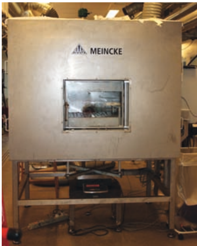
Figur 3. Pilot plant bageovn som simulerer en industriel tunnelovn (eget foto). Hulppladerne til luftfordeling kan skimtes gennem ruden. Bagepladen hviler på vægten nedenunder ovnen.
