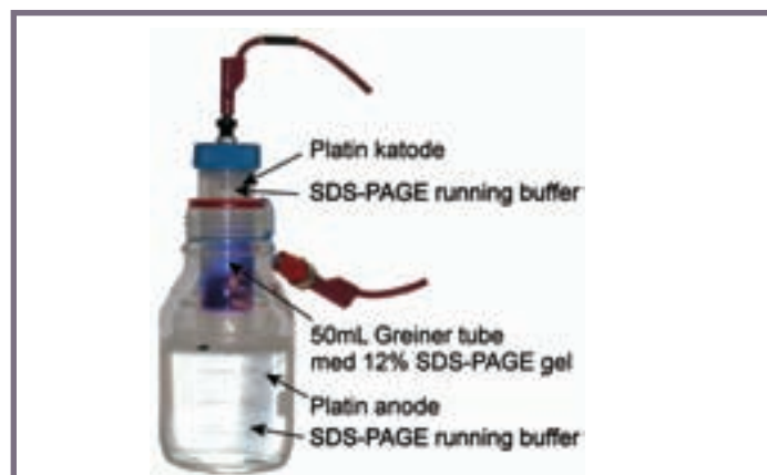
Det simple, præparative SDS-PAGE-system benyttet i dette studie. Systemet består af et 50 mL Greiner-rør, hvori der er støbt en 12% SDS-PAGE-gel. Gelen er i begge ender i kontakt med bufferreservoirer, der er forsynet med platinelektroder, hvormed den nødvendige spænding kan skabes over gelen. Prøven påføres i toppen af Greiner-røret.
