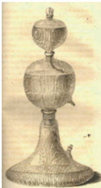
Figur 3. Dr. Nooths forbedrede apparat til fremstilling af kunstigt mineralvand. Udstyret, der minder om et Kipp-apparat, er helt i glas, hvorved man undgår den svineblære, der indgik i Priestleys oprindelige udstyr og som gav vandet: »an urinous flavour; and this taste was, in general, so predominant, that it could not be swallowed without some degree of reluctance« [11]. Det er måske ikke så sært, at Priestley blev stødt over denne bemærkning og til gengæld antydede, at en tjener måtte have tisset i det vand, Nooth benyttede.
