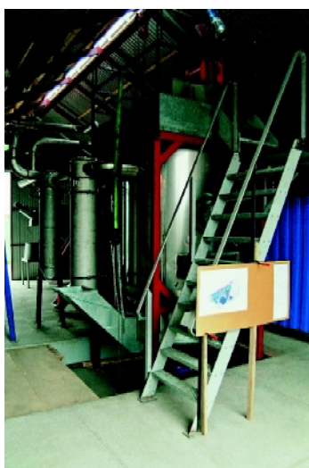
Figur 5. Nyudviklet træflisforgasser opstillet i Græsted.
