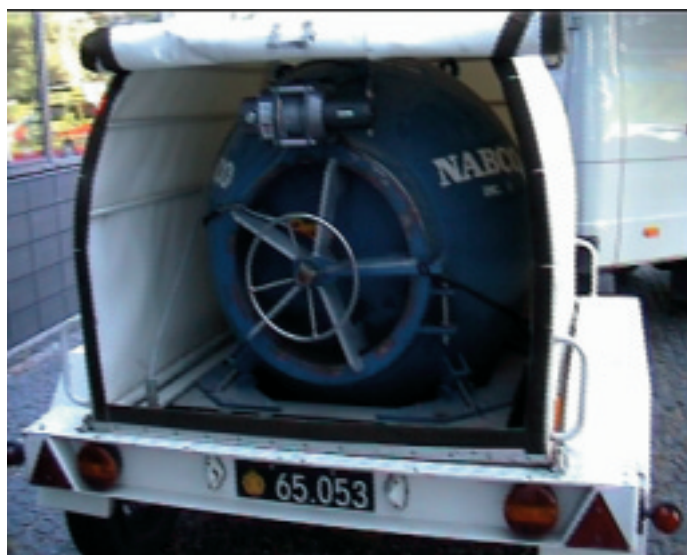
Stålkuglen tillader transport af sprængfarlige emner.
