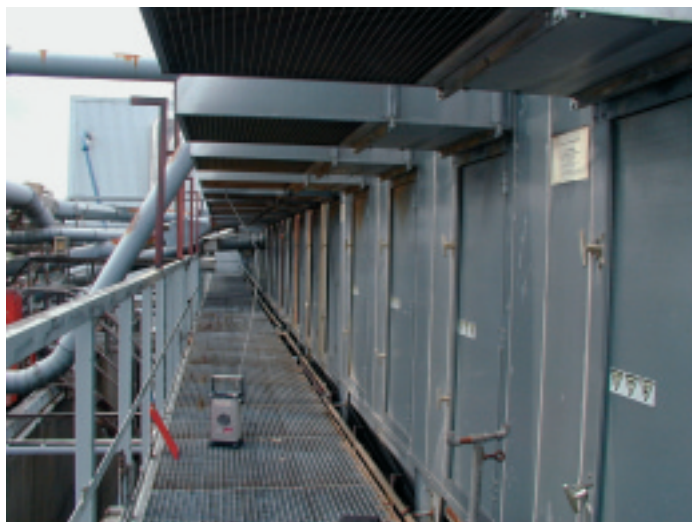
Måling med DataRAM i afkast fra posefilter.
