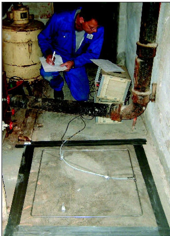
Figur 3. Indtrængningen af perchlorethylen fra forurenede jord under et kældergulv måles vha. foliemetoden. Målestedet er udpeget vha. »sniffermetoden«.
