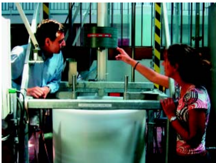
Figur 3. Studerende ved Institut for Kemiteknik arbejder, i samarbejde med Hempel's Skibsfarve-fabrik, på udvikling af effektive og miljøvenlige bundmalinger til skibe. På billedet ses en skibssimulator i form af en cylinder, som ved neddykning i den hvide plasttank kan rotere ved forskellige betingelser i kunstigt havvand.
