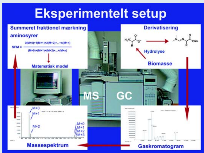
Figur 3. Skematisk oversigt over den anvendte GC-MS-metode.
