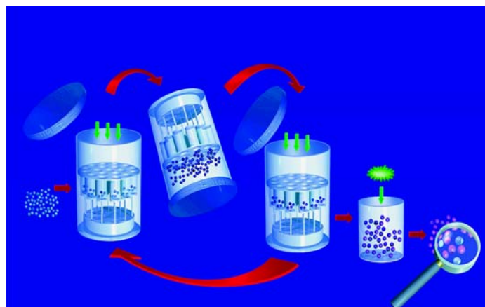
Figur 4. En 20 brønds tefloncylinder (multiple column peptide synthesizer [12] (MCPS)) udgør den praktiske foranstaltning ved fremstilling af kombinatoriske biblioteker.
