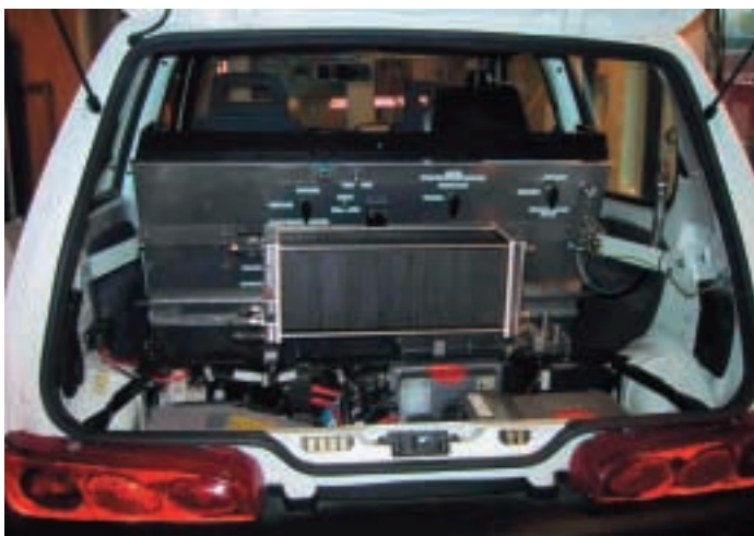
Figur 1. Brændselscellebil. Kombineret batteri- og brændselscelledreven bil under udvikling af IRD A/S og Fiat baseret på en Fiat Seicento Elettra Van. Brændselscellen, som drives af hydrogen fra 6 trykflasker à 9 liter og 200 bar, oplader batteriet og driver sammen hermed motoren. Batteriet optager derudover energien ved bremsning og frigiver den ved acceleration. Brændselscellen er på 2,5 kW, batteriet på 6,3 kWh, motoren på 15 kW og rækkevidden 135 km ved bykørsel. (Kilde IRD Fuel Cells).
