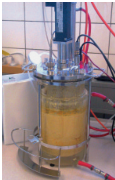
Figur 3. Opsætning til karakterisering af ethanolgæringer fra tørformalet majs. Mæsken er grødagtig med opslæmmede grove partikler.
