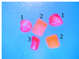
Figur 5. Forskellige polymerer indfarvet med perylenfarvestof efter en SC CO 2 -metode benyttet under THOR-programmet. (1) kløvet HD-polyethylenkorn, (2) polycarbonatblok, (3) polystyrenkorn. Foto: CISMI, KU
