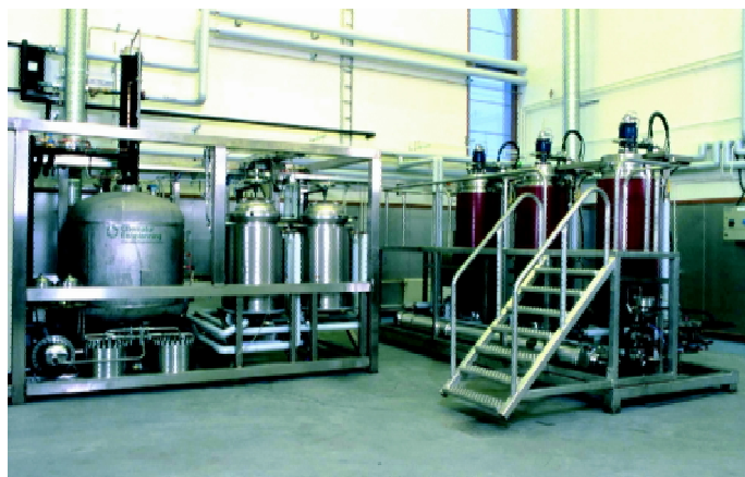
Figur 8. Opstillet SC CO 2 -ekstraktionsanlæg fra Chematur Engineering. Anlægget består af tre serieforbundne ekstraktionsbeholdere på 200 liter (højre side af billedet). Til venstre ses opsamlingsbeholderen for den flydende CO 2 samt separator, produktbeholder og forskellige pumpe- og køle/varmeanheder. Kilde: Chematur Engineering AB.
