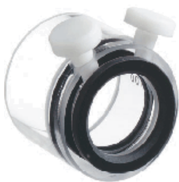
Figur 3. Quartz Suprasil celle fra Hellma til CD-spektroskopi.
