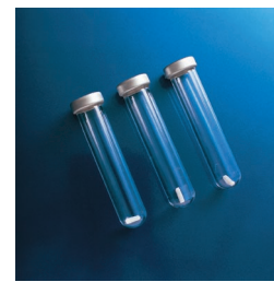
Figur 4. Reaktionskolber til anvendelse ved mikrobølgebaseret kemi. Kolberne lukkes ved hjælp af crimp caps.
