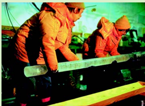
En iskerne fra 1,5 km dybde tages ud af boret ved Dye-3 i 1981 af Palina Kristinsdottir og Sigfus Johnsen.
