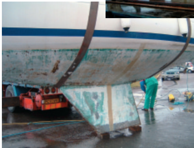
Figur 2. Båd bundmalet med hård enzymholdig maling. Malingen er ikke særlig effektiv, idet bunden er begroet med alger og rurer efter 6 måneder i vandet.
