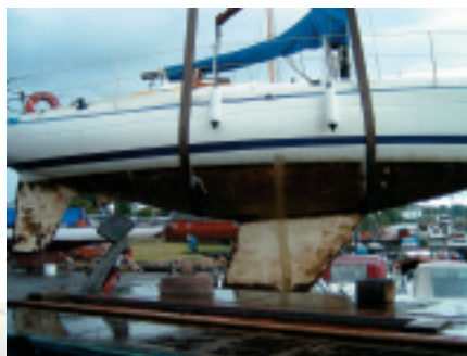
Figur 1. Båd bundmalet med selvpolerende enzymholdig maling. Der ses kun ganske let begroining – men malingen er næsten også poleret helt væk. Bemærk striben midt på båden fra fribord til køl. Det er en kobberbaseret kontrolmaling, der ikke kan opfylde Miljøstyrelsens 2003 bekendtgørelse om udludning af kobber fra bundmalinger til lystbåde.
