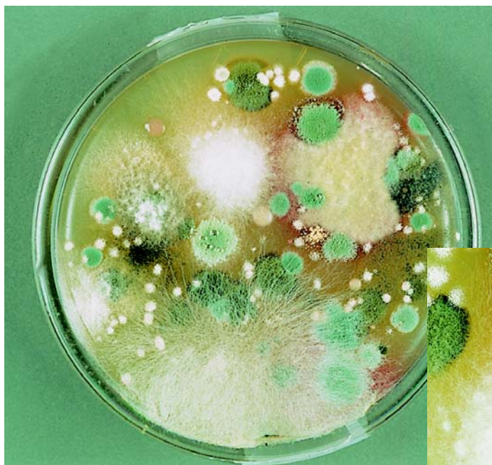
Figur 2. Aftryksplade fra byggemateriale, der viser massiv vækst af Penicillium , Aspergillus og Cladosporium arter.
