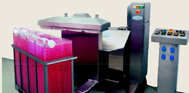
Cellefabrik i robotmodel. Den trucklignende indretning bagved kan løfte og dreje fabrikken, så man kan hælde medium i den og hælde medie fra den på en nem måde.
