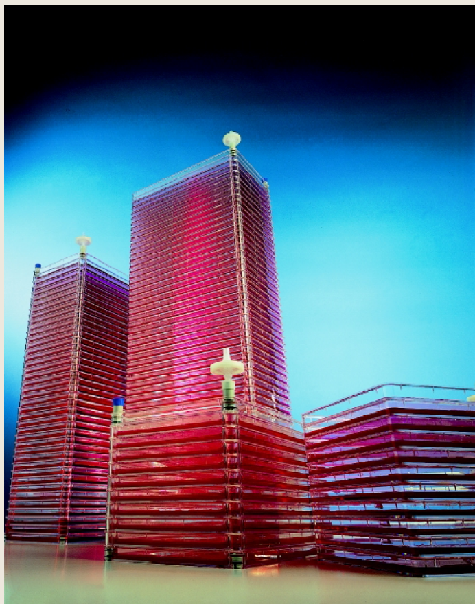
Stationær cellefabrik af avanceret plast, som cellerne kan lide. Den røde farve er pH-indikatoren i kulturvæsken, som skal være inden for et snævert pH-interval nær 7.4.
