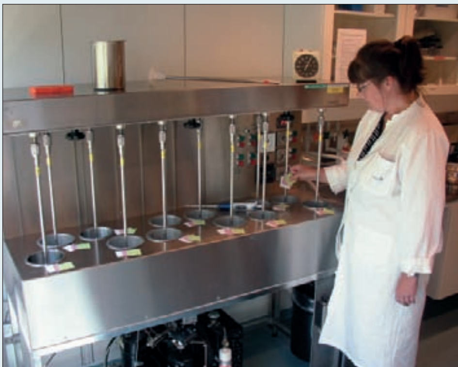
Figur 4. Et Terg-o-tometer. Opstillingen tillader samtidig udførelse af 12 vaskebehandlinger med op til 1 L vaskevæske i hver og synkron omrøring. Alle bægre (hvoraf et ekstra er vist oven på apparatet) stikker ned i et termostateret vandbad. Omrørerstængerne (hvoraf en ekstra er vist oven på apparatet) giver en omrøring svarende til den, man har i en amerikansk vaskemaskine. Billedet viser begyndelsen på en vask med nogle typiske tekniske smudslapper, her lapper med solbær og græs og hvide sporingslapper til konstatering af eventuel farveoverførsel.
