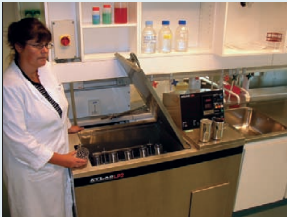
Figur 5. Et Launder-ometer. Bægre som dem vist til højre (ét med låg, ét uden) fyldes med testtekstiler, vaskevæske og eventuelt stålkugler, som dem Marianne Valente holder frem, hvorefter de lukkes og anbringes i holderen nede i vandkarret. De lukkede beholdere roterer i karret under vasken og derved simuleres den mekaniske behandling, som vasketøjet oplever i en typisk europæisk vaskemaskine. Apparatet kan programmeres til at varme vandet i karret op efter et bestemt temperaturprogram – ligesom en vaskemaskine, der tager koldt vand ind og varmer det op til f.eks. 40 °C i løbet af en given tid.
